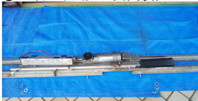
⑤ 老朽化自動ドア開閉装置
